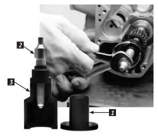
PINION GEAR INSTALLER & PULLER
