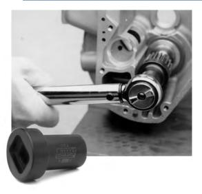
PINION GEAR NUT SOCKET
