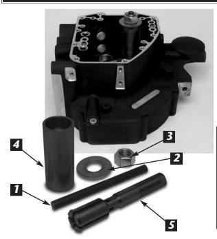
INNER CAM BEARING PULLER
