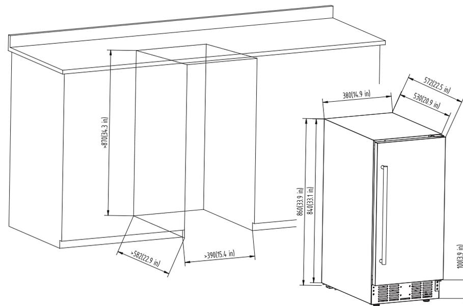
Pour une installation autoportant, suggérez de laisser 2 pouces d'espace entre le côté, l'arrière et le mur de l'appareil. De plus, un dégagement suffisant (160°) doit être maintenu pour permettre à la porte de s'ouvrir correctement et complètement.
