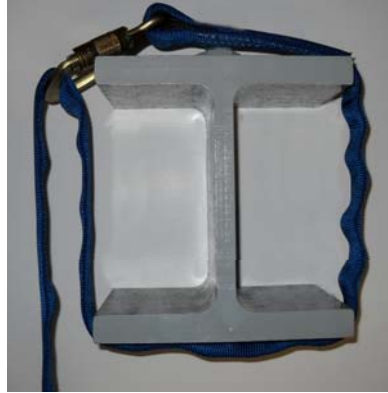
Conexión incorrecta del amarre
