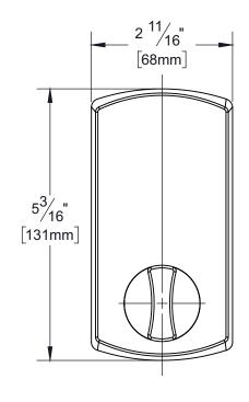
Door Prep: Cross Bore 2 1/8", Edge Bore 1", Latch Face 1" x 2 1/4"
