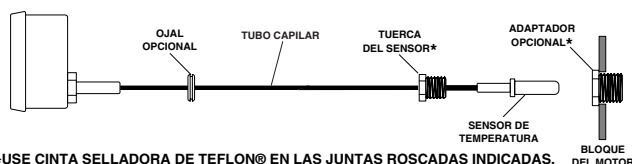
Figura 6. Conexiones del indicador mecánico de temperatura de agua
