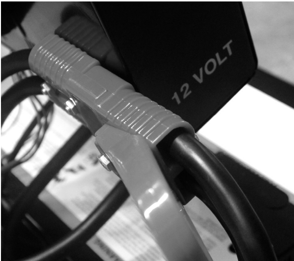
Connexion rapide 12 volts (rouge) avec connexion rapide de sélection de tension attachée
