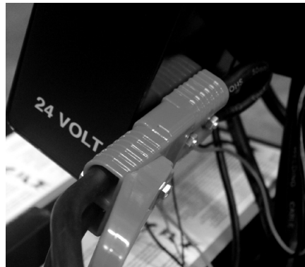
Conexión rápida de 24 V (rojo) con conexión rápida de selección de tensión agregada
