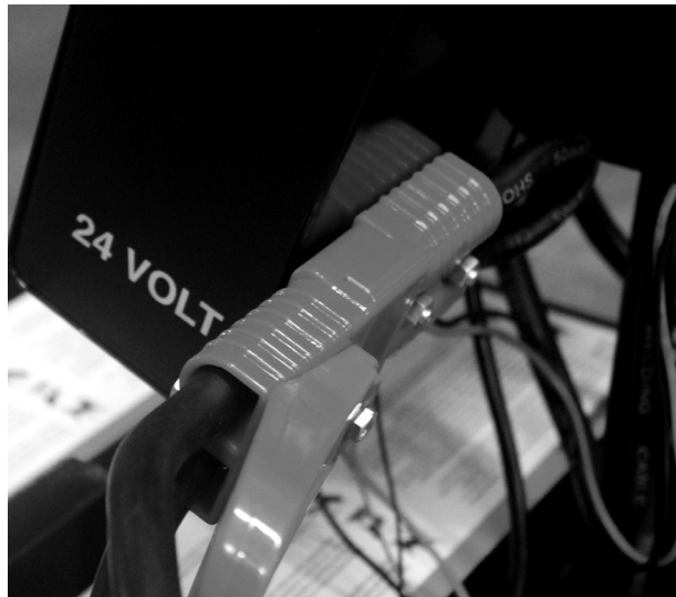
Connexion rapide 24 volts (rouge) avec connexion rapide de sélection de tension attachée
