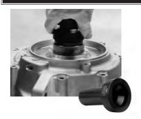
SPROCKET SHAFT SEAL INSTALLER TOOL
