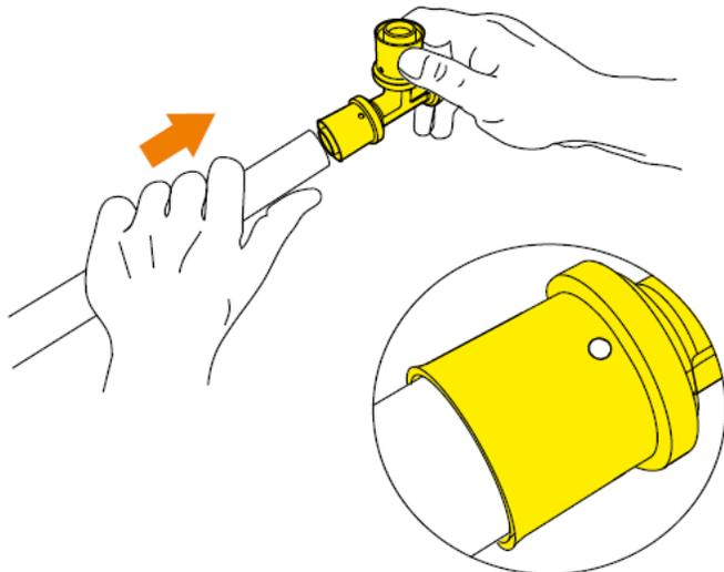
3. Inserte el accesorio en la tubería comprobando a través de los orificios de inspección de la manga que la tubería se haya insertado correctamente. Retire cualquier material residual que quede dentro de la tubería.
