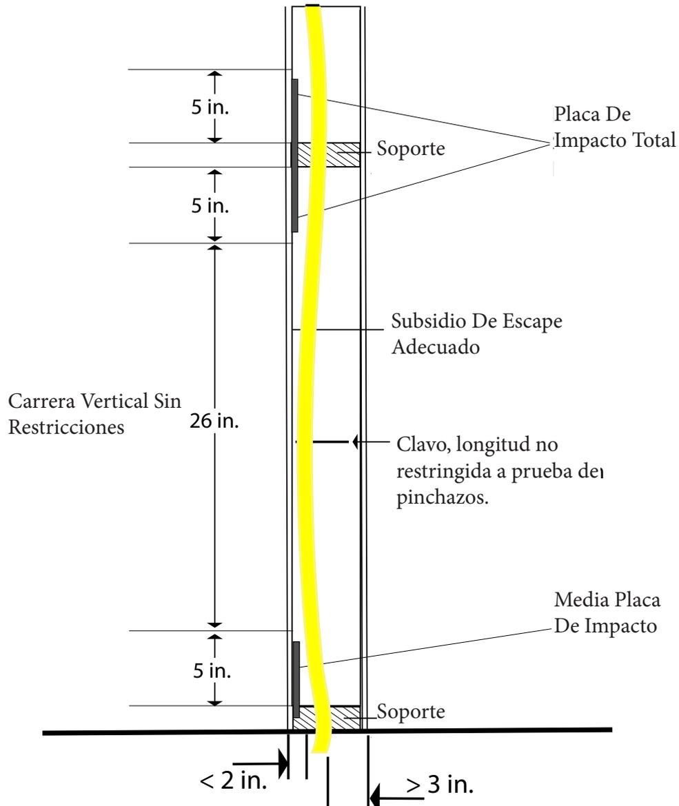
B. En puntos de soporte ocultos y puntos de penetración dentro de 2 a 3 pulgadas de cualquier travesaño, viga, placa, etc., se requieren protectores de cuarto en el área de apoyo.
