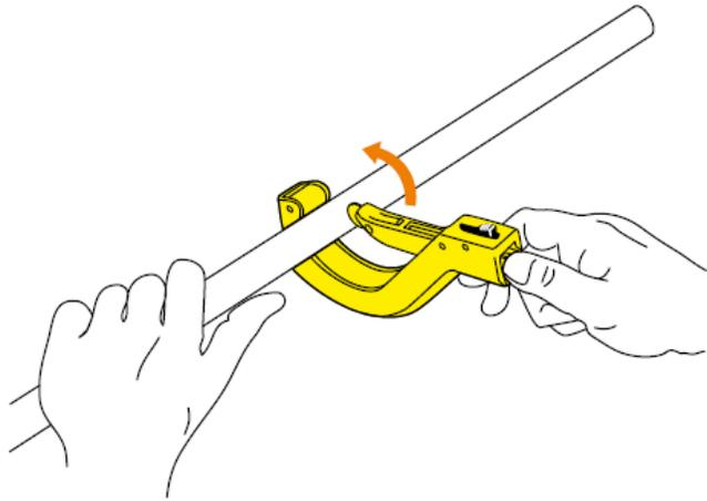
1. Corta el tubo en ángulo recto con un cortatubos adecuado. Compruebe la pulcritud y el afilado de la cuchilla para evitar cualquier ovalización o daño en la tubería
