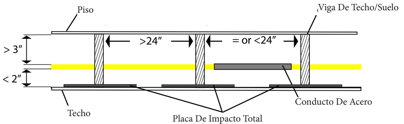
D. Las tuberías de más de 32 mm de diámetro nominal (26 mm de diámetro interior) instaladas dentro de una cavidad de pared hueca oculta de 2" x 4" de construcción deberán estar protegidas a lo largo de todo el recorrido oculto con un conducto metálico enrollado en tiras, o con una tubería de sección 40.
