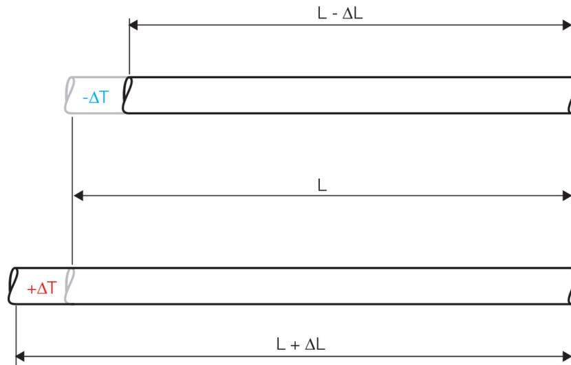
La prevención de dicha variación en la longitud del material debería generar una tensión de tracción (con  $\Delta T < 0$ ) o una tensión de compresión (con  $\Delta T > 0$ ) dada por:
