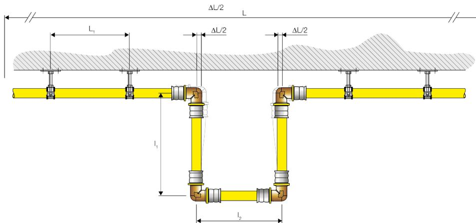
La longitud total de la curva de expansión "omega"  $L_B$  [in] se calcula mediante la fórmula (que también se muestra en el siguiente diagrama):
