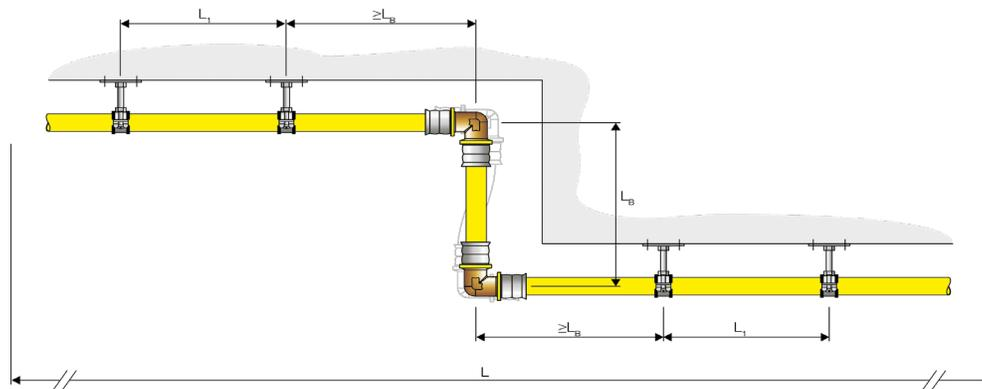
La longitud del brazo flexible  $L_B$  [mm] se calcula mediante la fórmula:
