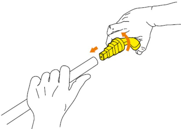
2. Calibre y bisele el tubo para obtener una circunferencia interior perfectamente redonda del tubo. Asegúrese siempre de que el escariador no tenga abolladuras o daños, ya que dañarían la tubería y comprometerían el sellado.
