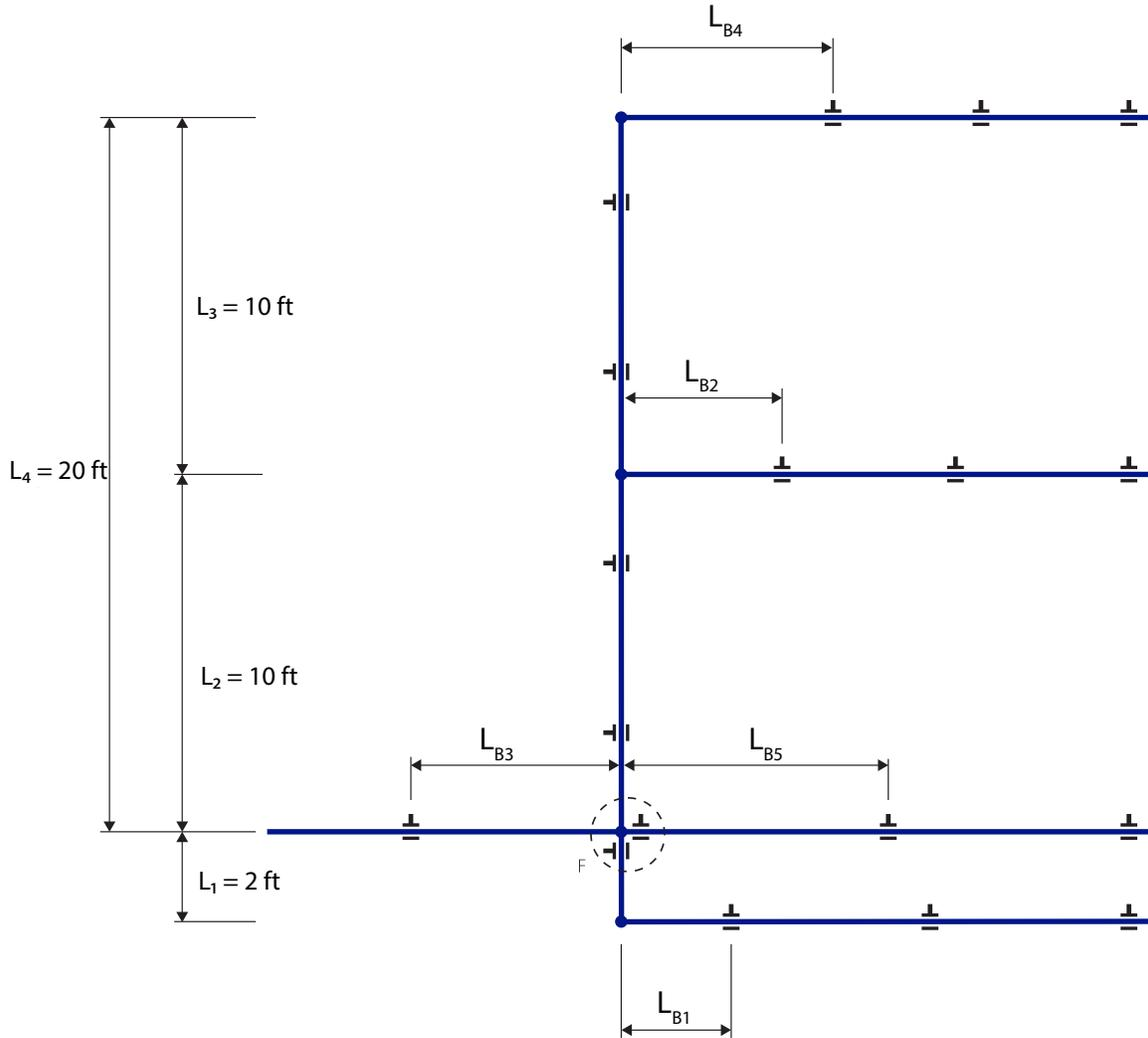
Las secciones de tubería  $L_{B3}$  y  $L_{B5}$  no están sujetas a flexión debido al punto de anclaje (F) cerca del ramal transversal.
