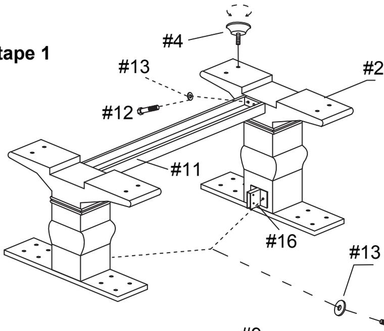
1. Utilisez les boulons (n° 17) et les rondelles (n° 13) pour fixer les connecteurs de la plaque de fer (n° 16) aux pieds (n° 2).
