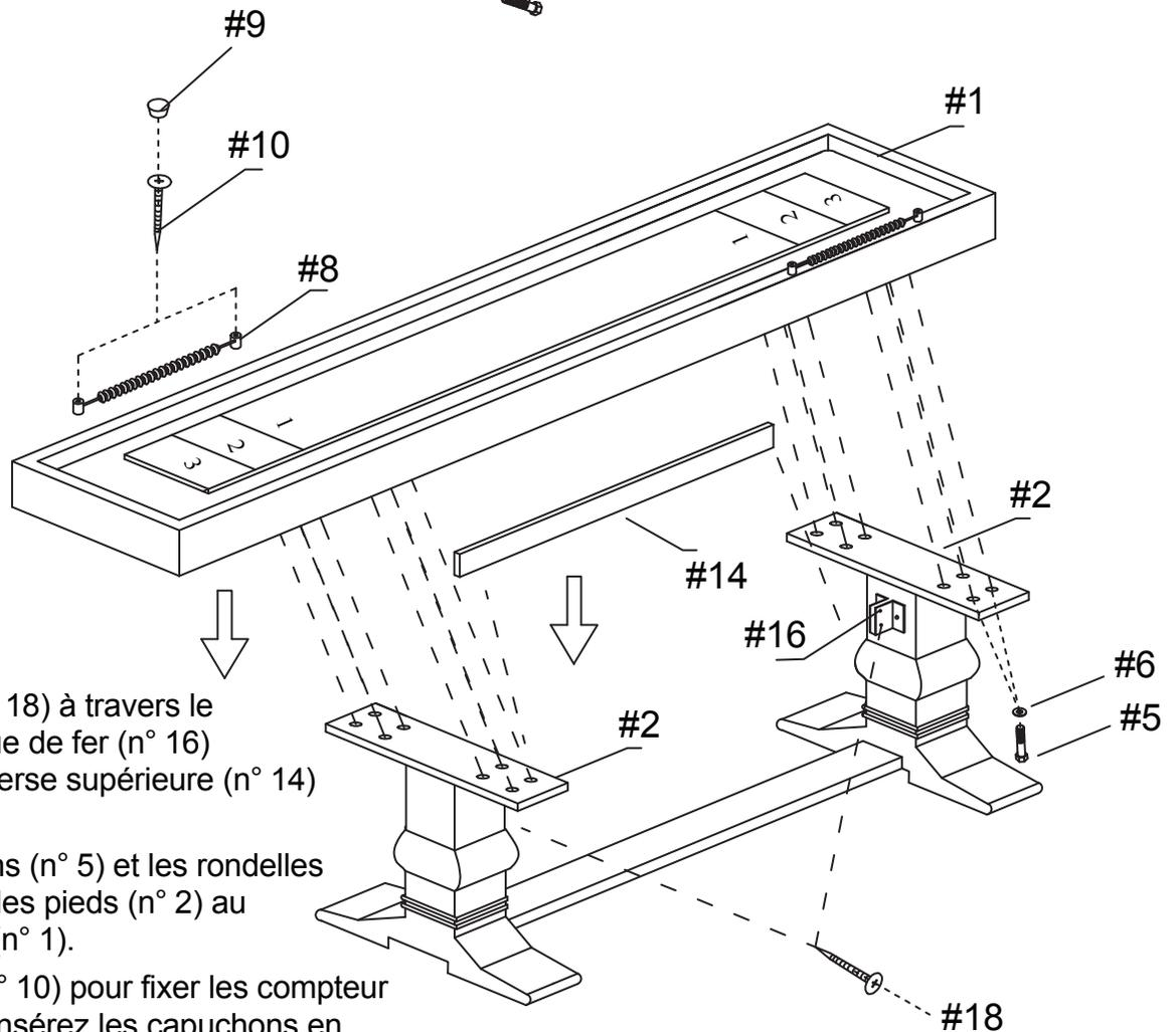
1. Utilisez les vis (n° 18) à travers le connecteur de plaque de fer (n° 16) pour attacher la traverse supérieure (n° 14) aux pieds (n° 2).
