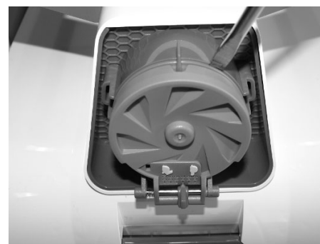
9.2: Utilisez un tournevis plat pour déboîter le clapet puis l'ôter.
