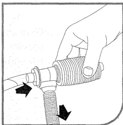
Pompez grace au siphon jusqu'a ce qu'il n'y ait plus d'air dans le tuyau, puis laissez votre couverture de piscine se vider.
