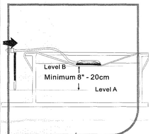
Placez la tête lestée au milieu de votre couverture de piscine, et connectez l'autre extrémité du tuyau au siphon. Assurez vous que la sortie du siphon est plus basse que la tête lestée.
